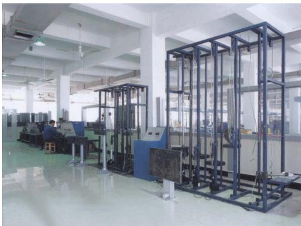
Испытательная лаборатория для проверочных испытаний срока службы исполнительных механизмов электроприводов и подъемных колонн
