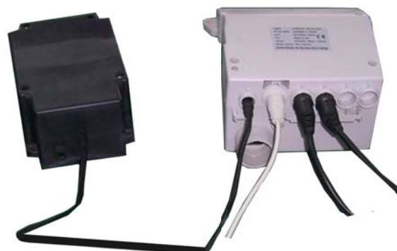
Подключение внешнего аккумулятора (слева) к блоку управления
