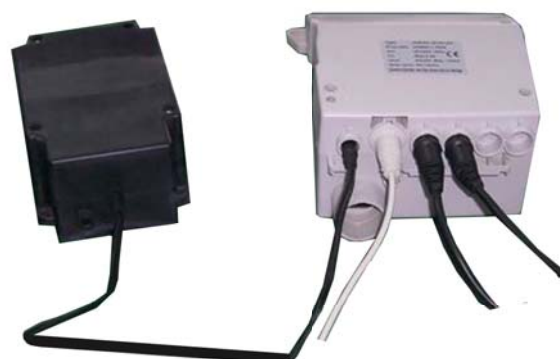
Подключение внешнего аккумулятора (слева) к блоку управления
